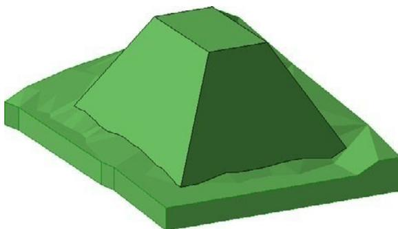
Come nuova caratteristica è che l'angolo di inclinazione del plateau è possibile regolare separatamente su ciascun lato. Quando si seleziona l'altopiano, l'hot spot viola viene visualizzato sul lato del pendio.
