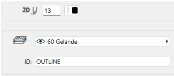
Im Abschnitt Ansicht können Benutzer das grafische Erscheinungsbild der Elemente definieren, z. B. den Stift, der für die Kante verwendet wird (in der neuen Oberfläche) und den Schraffur- und Füllhintergrund (in der alten Oberfläche, die durch Klicken auf die Schaltfläche unten links im Dialogfeld erreicht werden kann).
